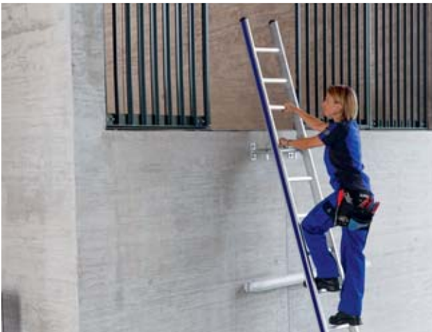
Bild 30 und 31: Blick und Körper zur Leiter gerichtet, Hände an den Sprossen und geeignete Tragmittel (angehängte Werkzeugtasche bzw. Umhängekiste)
