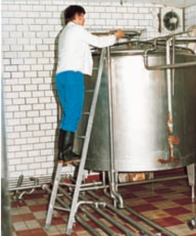
Bild 31: Leiter mit Einhängvorrichtung am Behälter
