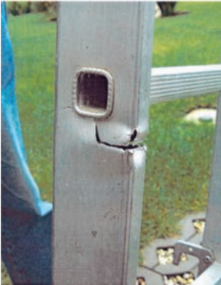
Bild 51: Stark beschädigte Leiter
